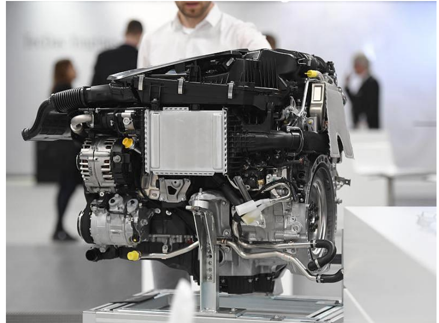
Reihen-6-Zylinder Dieselmotor von Mercedes
