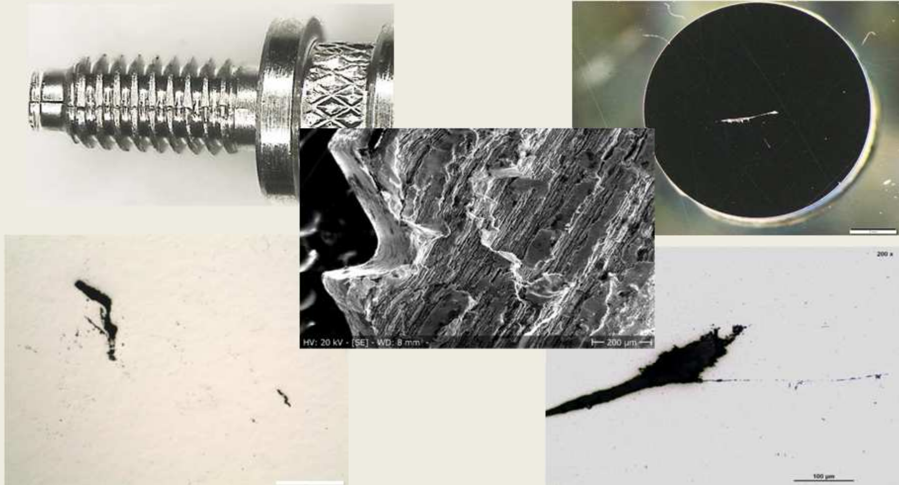
Pressfehler - Zweiwachsbildung am Pressende
