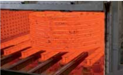
*Die Ringe mit Außendurchmessern bis zu 7 m werden im Ganzen geglüht*
