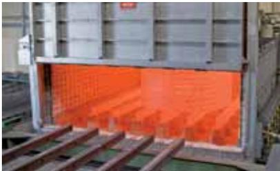
*Der Kammerofen fasst Bauteile mit Abmessungen bis zu 7 x 7 x 2 m und einem Gesamtgewicht von 40 t*
