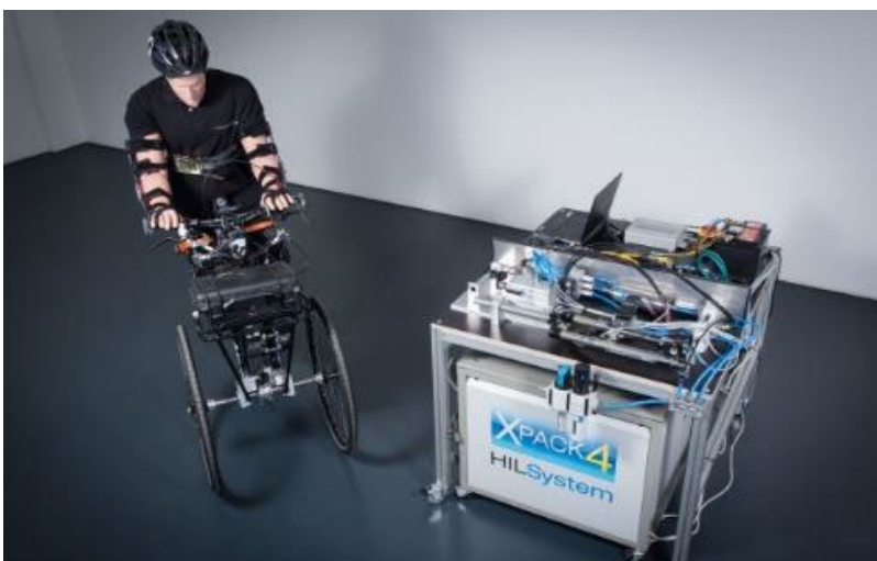
Abb. 2: Fahrerassistenzsysteme für E-Bikes, selbstfahrender Versuchsträger und Hardware-in-the-Loop-Prüfstand für E-Bike-ABS aus abgeschlossenem Projekt „BikeSafe“
