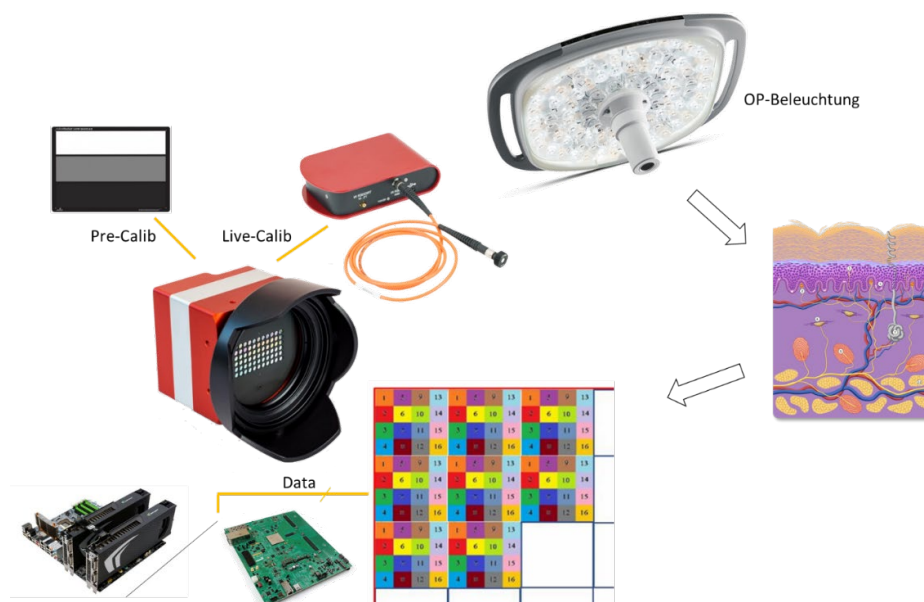
Abb. 10: Aufbau zur hyperspektralen klinischen Bildgebung unter Einsatz von echtzeitfähiger Hardware
