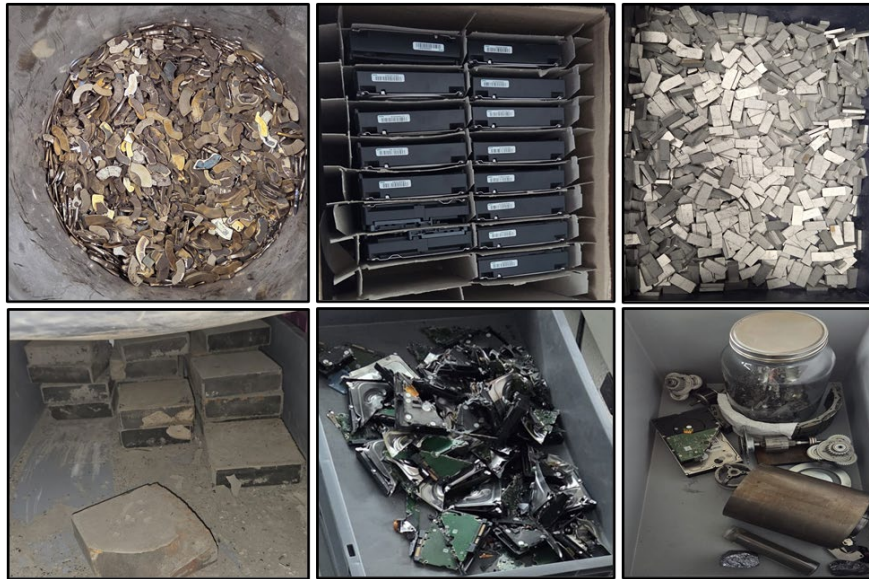
Abb. 11: Prozesskette für das Magnetrecycling (oben) und typische Magnetquellen (unten) für das Recycling von NdFeB. Bild: HS Pforzheim
