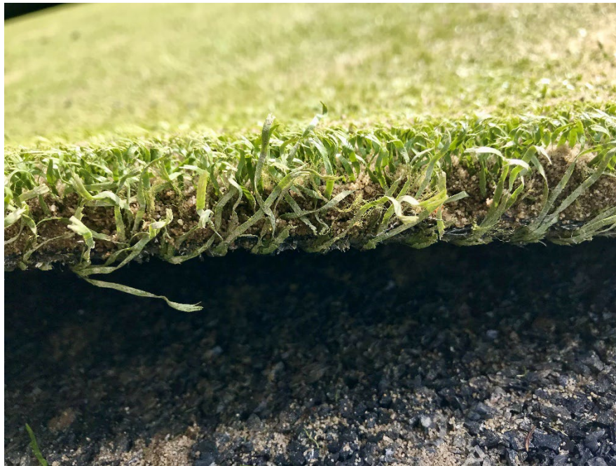
Abb. 12: Querschnitt eines Kunstrasens mit den PE-Fasern, Quarzsand, Performance Infill und Teppichrücken sowie dem schwarzen ELT. Quelle: Deimling, PR-Recycling
