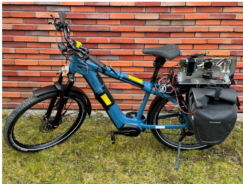
Abb. 8: S-Pedelec-Versuchsträger mit ABS Gen2 sowie Hardware für elektronischen, softwarebasierten Bremskraftverteiler
