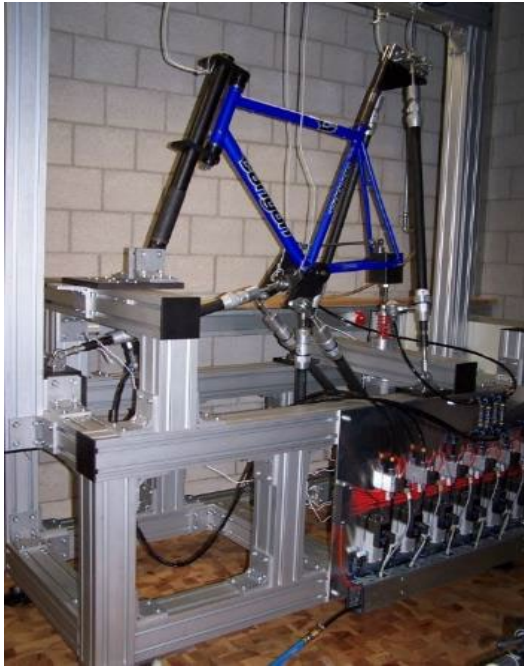
Abb. 3: Prüfstandtechnik für Fahrräder und E-Bikes, Multiforce-Prüfstand zur Dauerprüfung von Fahrrad-Rahmen
