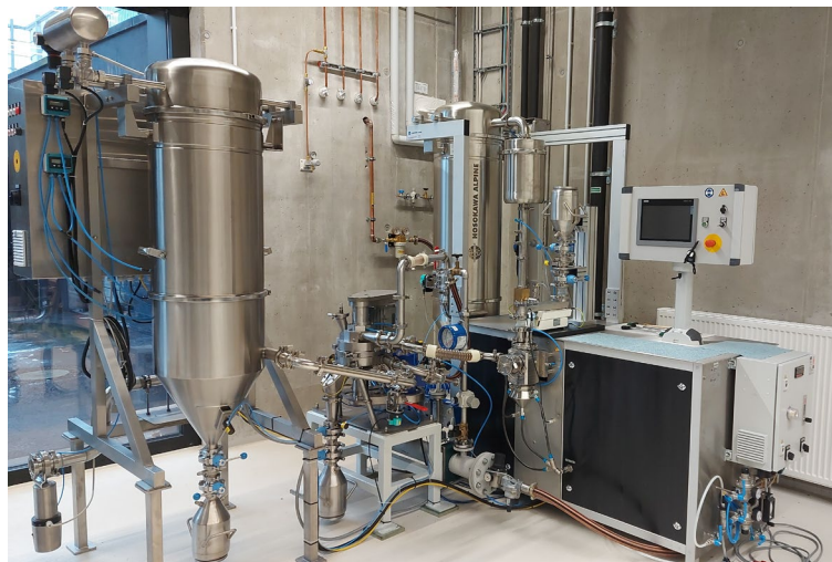
Abb. 18: Multiprozessanlage mit Jetmühle und Anbau, bestehend aus Sieber und Filter
