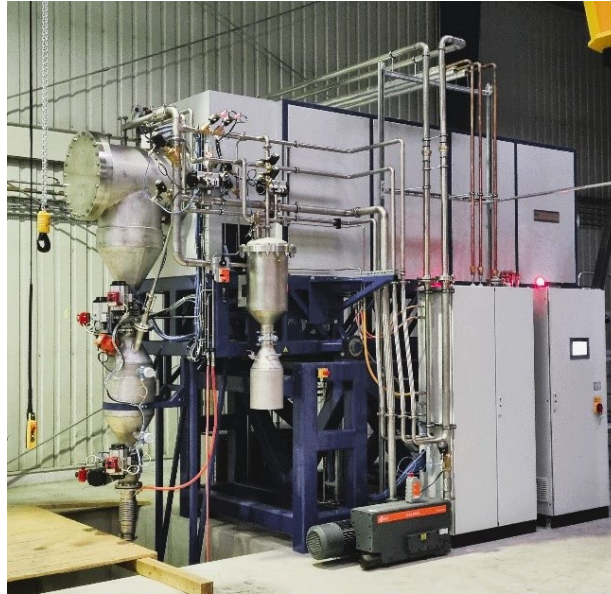
Abb. 6: HPMS-Reaktor (HMG) zur Herstellung von Magnetpulver aus EOL-Magneten
