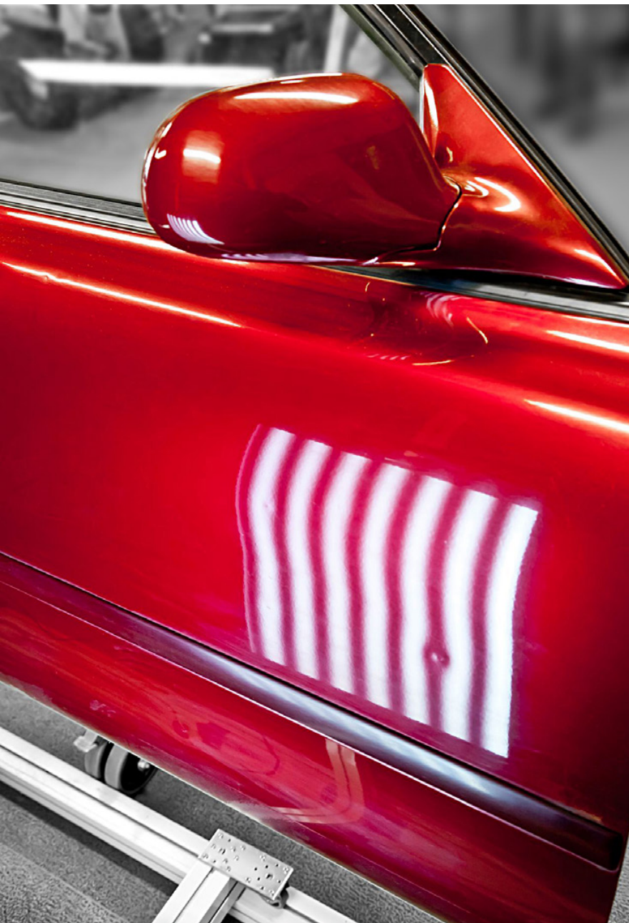
Abbildung 1: Streifenmuster auf einer Autotür mit Delle (Quelle: Fraunhofer IOSB, Karlsruhe).
