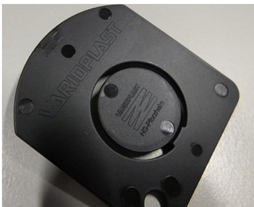
Versuchsteil ohne Bindenaht.
