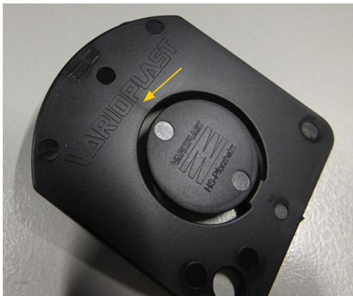
Versuchsteil mit Bindenaht.
