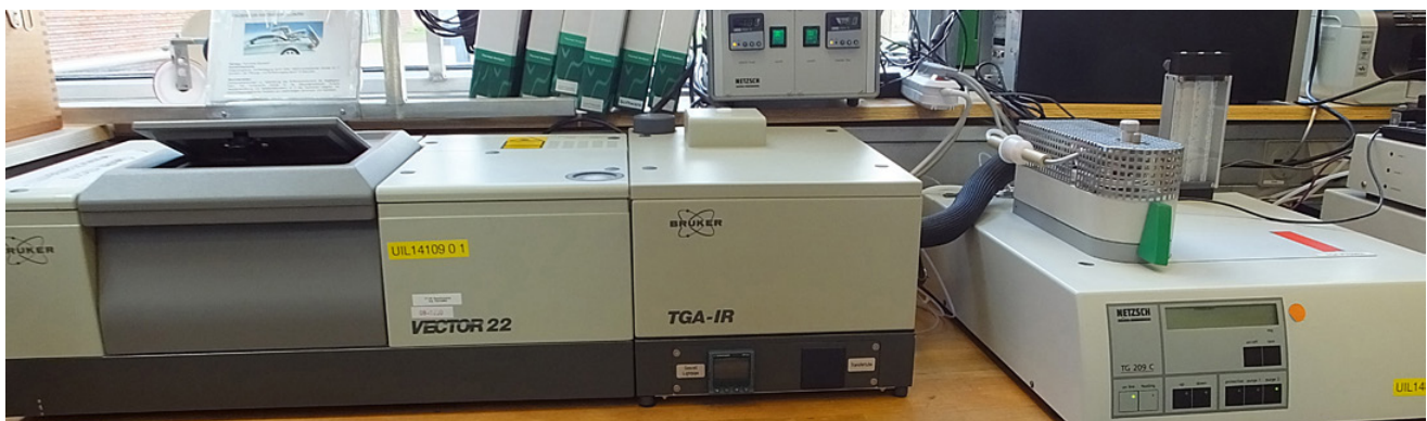
Fourier-Transformations-Infrarotspektroskop (FTIR) + Thermogravimetrie (TG). Foto: Prof. Dr.-Ing. G. Frey
