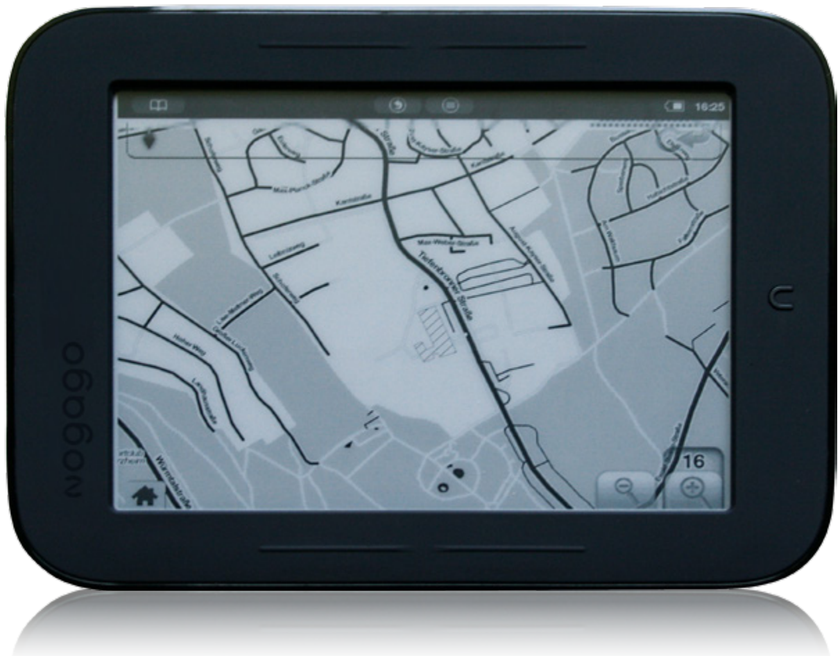
Prototyp Karten-Appliance: Gute Lesbarkeit im Freien und 2 Monate Nutzung durch Einsatz eines reflektiven eInk-Display. (Bildquelle: Volz Innovation GmbH)
