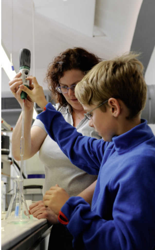
Überprüfung einer Nickelbad-Probe in der Galvanik.
