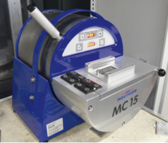
Abb. 2 Mini-Vakuum-Gießanlage Foto: Andreas Zilly
