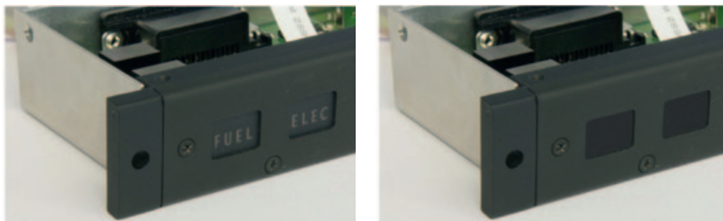
Abbildung 4: links: ausgeschaltete Anzeige ohne Black-Panel-Effekt, rechts: ausgeschaltete Anzeige mit Black-Panel-Methode der HS Pforzheim.
