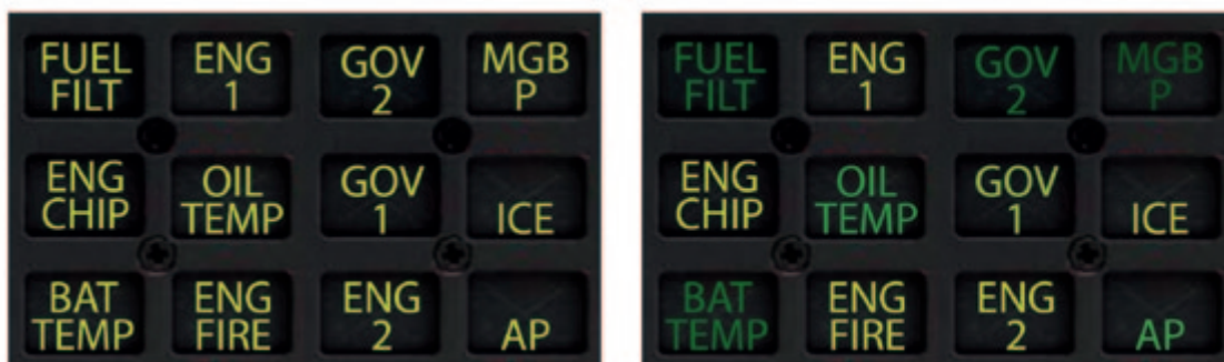
Abbildung 1: Simulation des Burn-in-Effekts, links: kein Burn-In, rechts: Burn-In, bei dem nicht mehr sicher erkannt werden kann, welche OLEDs leuchten.
