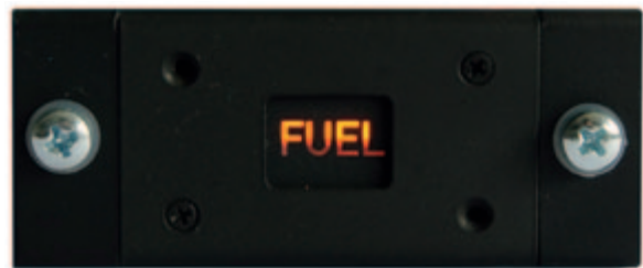
Abbildung 5: Redundanz-Muster, realisiert mit einer zweizeiligen OLED, in der Abbildung ist die untere Zeile ausgeschaltet.
