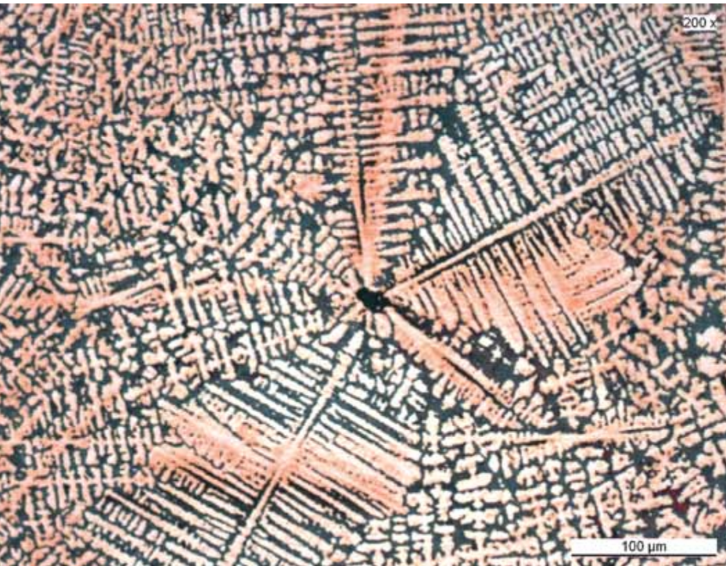
Gefügeaufnahme einer gegossenen Kupferlegierung (200-fach vergrößert). Foto: Dorothea Nobiling
