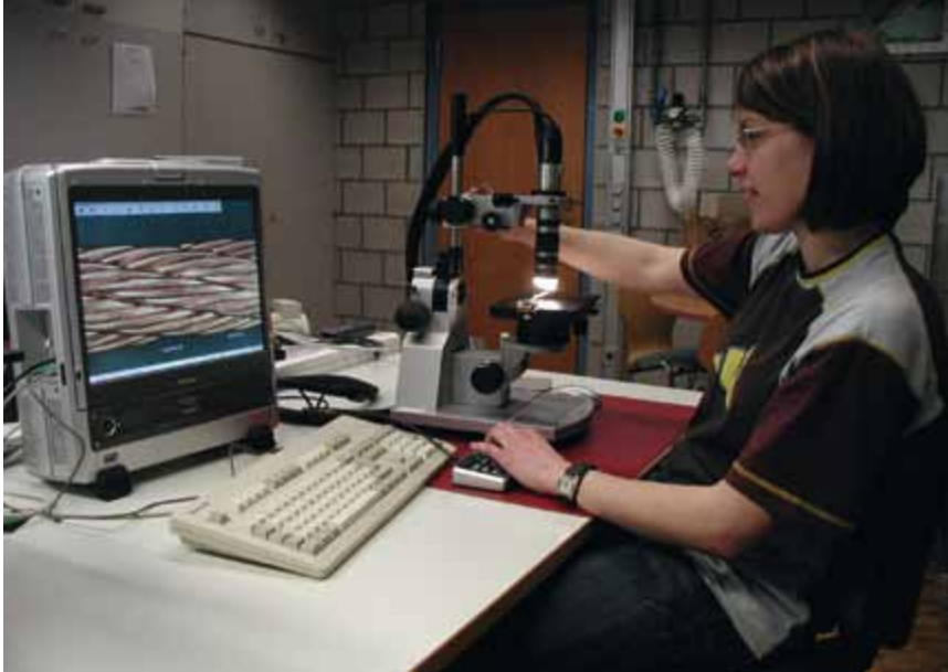
links: Dorothea Nobiling bei der Mikroskopie von Drahtbrüchen. Foto: Andreas Zilly
