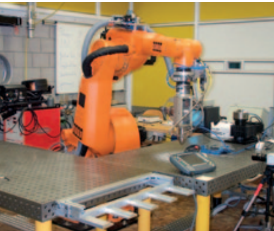
Kompakter Werkzeugaufbau beim Laserauftragschweißen ermöglicht den Einsatz von Industrierobotern.
