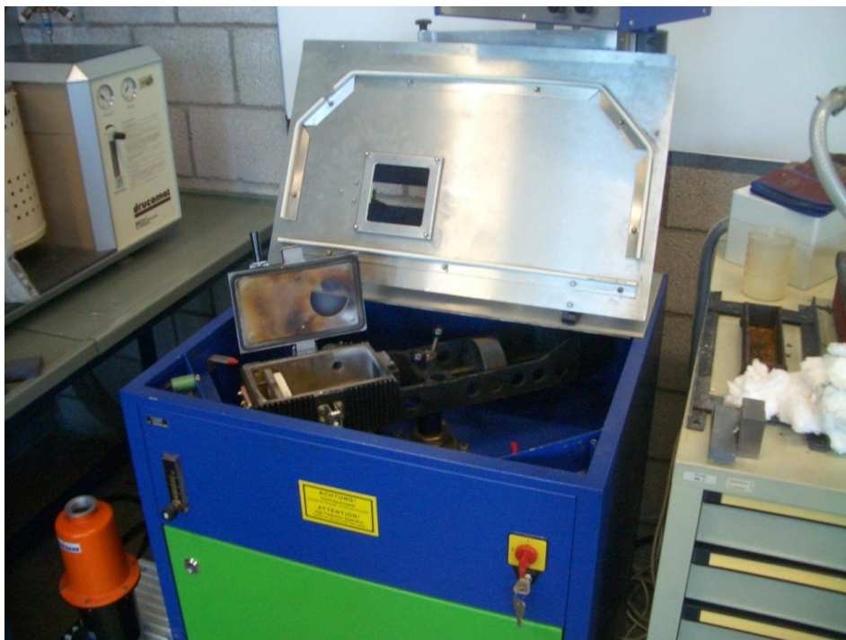
Abbildung 7: Die Vacutherm 3,3 Titan Anlage mit geöffneter Sicherungsklappe- und Schleuderkammer
