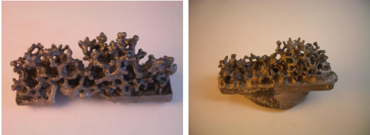
Abbildung 19: Titangussproben 20PPI; links Werkstoff 1, rechts Werkstoff 2
