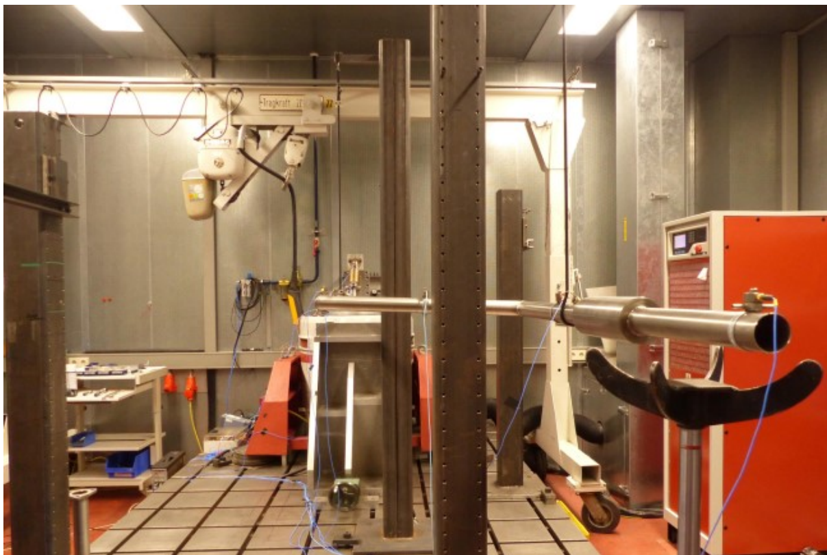
Abbildung 7-2: Versuchsaufbau Abgasanlage mit Entkoppelelement
