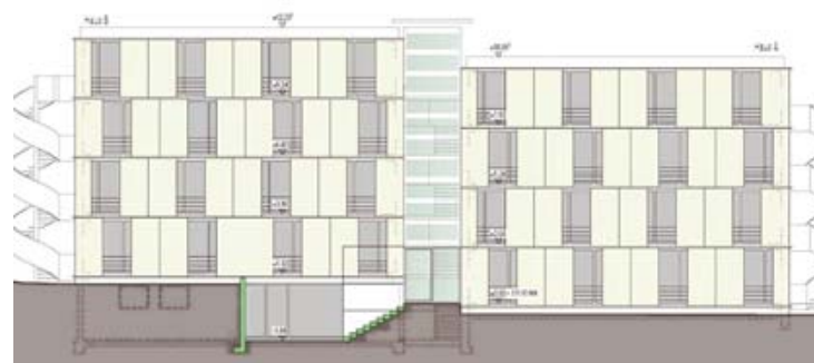
Zwei versetzte Gebäudeteile bilden den Neubau, in den Studenten zum Wintersemester 2011/2012 einziehen können. Der viergeschossige Bau besteht fast komplett aus Holz.
