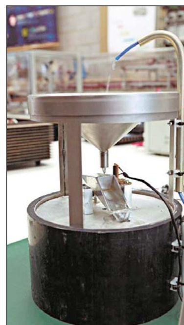
Der Regenmengenmesser funktioniert nach dem Kippplöfchelprinzip.
